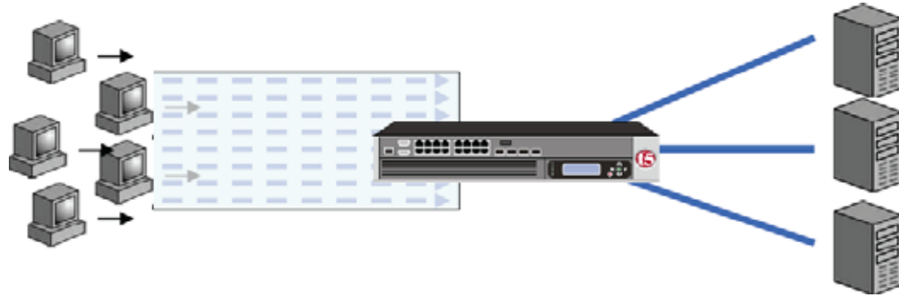
Tecnologia de gerenciamento de conexões reduz o ônus do TCP nos servidores
